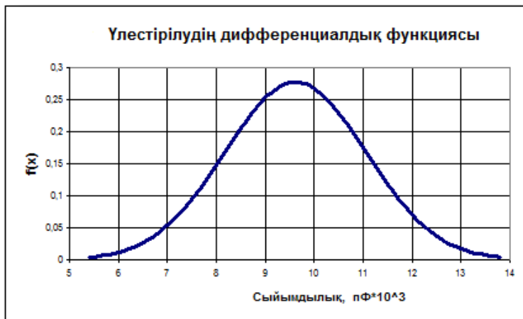
1.3 - Сурет. Пьезоэлемент пластиналар сыйымдылықтары үлестірілуінің дифференциалды функциясы
