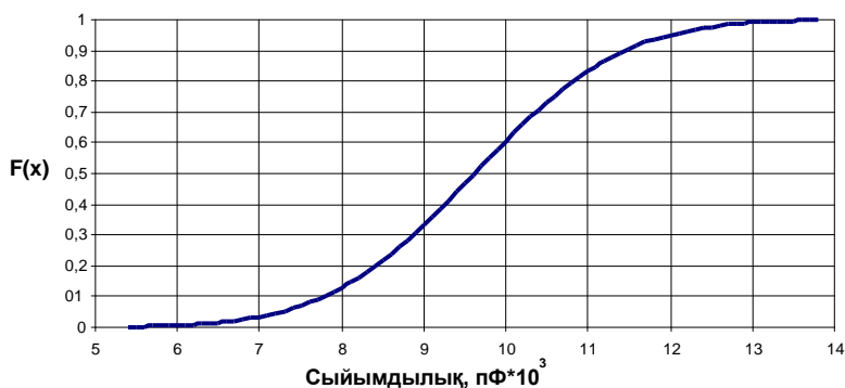
1.2- Сурет. Пьезоэлемент пластиналар сыйымдылықтары үлестірілуінің интегралды функциясы
